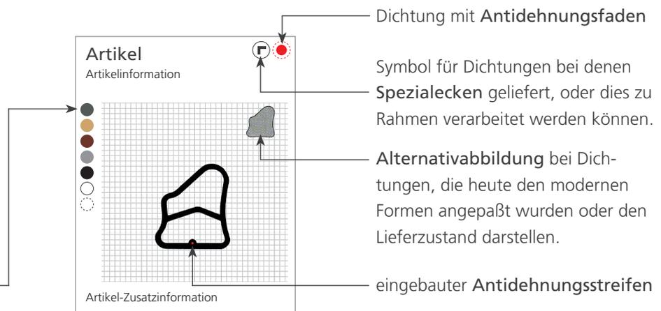
Die gängigsten Dichtungen sind mittlerweile mit einem Antidehnungsfaden ausgerüstet, um die Längenstreckung während der Montage zu vermeiden und so auch lästige und zeitraubende Nacharbeiten.
