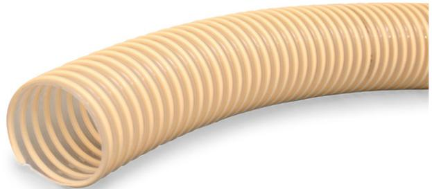
Abriebfester Absaug- und Förderschlauch für abrasive Feststoffe wie Stäube, Pulver, Fasern, Späne und Granulate, auch für gasförmige und flüssige Medien, flexibel, innen glatt, gute Chemikalien-, UV-, und Ozonbeständigkeit.
